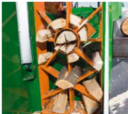
Speciális hasítóké (F0002070) 2, 6 és 12 hasáb előállításához egy munkamenetben.
