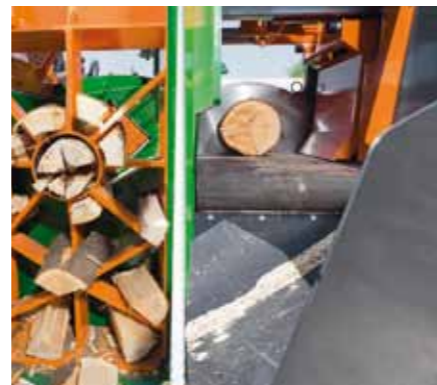
OnlyCut: csak fűrészelés hasítás nélkül (0), különleges felszerelésként rendelhető.
