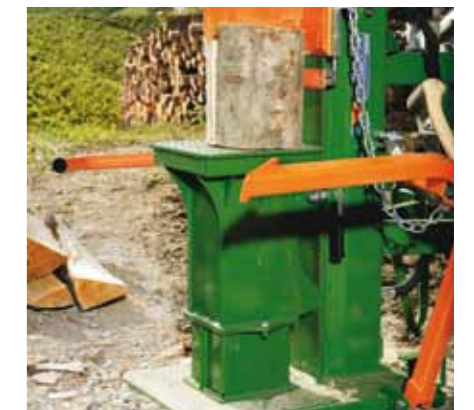
Állítható magasságú hasítóasztal (F0002538 il. F0002564) rövidfa hasításához (35/55 cm)
