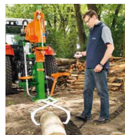
WF csörlő rönkfogóval és rádiójeles vezérléssel
