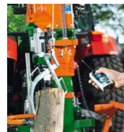
WF csörlő rádiójeles vezérléssel
