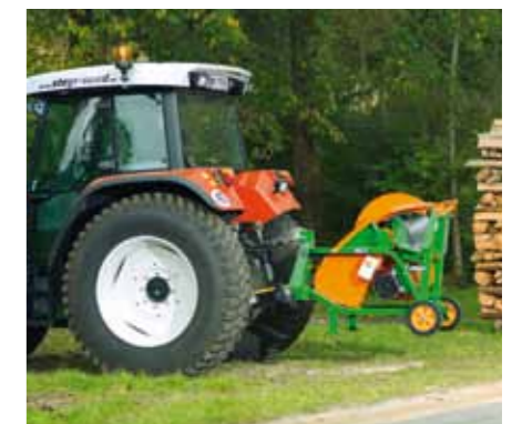
A hárompontos csatlakozó segítségével kényelmesen és gyorsan a munka helyszínére szállíthatja a kardánhajtású billenővályús GS fűrészgépet.
