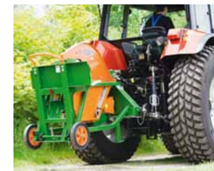
A hárompontos csatlakozó segítségével kényelmesen és gyorsan a munka helyszínére szállíthatja a billenővályús fűrészgépet.
